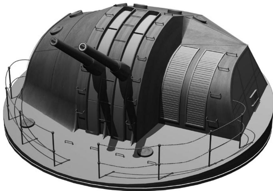
連続発射試験に成功した。これが89式12.7センチ連装高角砲である。10年後に大和型にも搭載され、活躍するハイ・アングル・ガンなのである。
